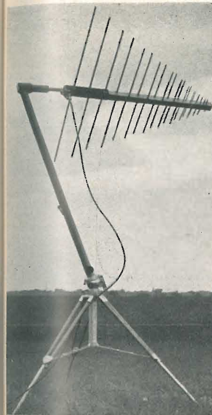
Fig. 9 - Antenna logaritmo-periodica per la banda di frequenza da 100 MHz a 1000 MHz.
